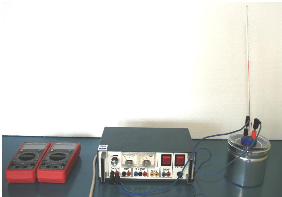
Slika 1. Kalorimetar s grijačem i termometrom
